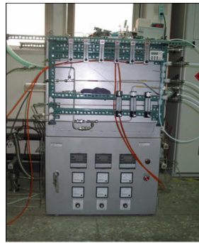
圖七 熱化學氣相沈積法合成奈米碳管
